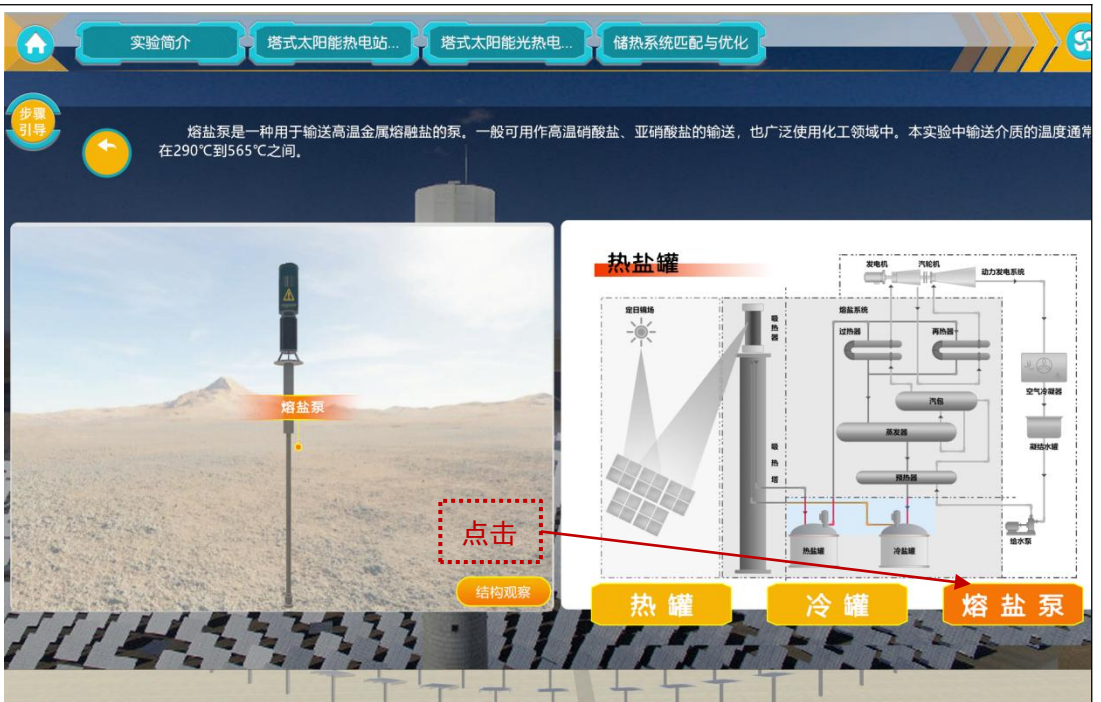
图 6d 塔式太阳能光热电站储热子系统——熔盐泵外观
