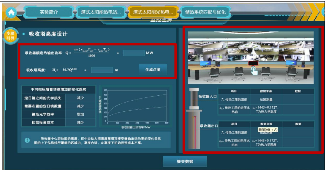
图 10b 吸收器额定热输出功率测算
