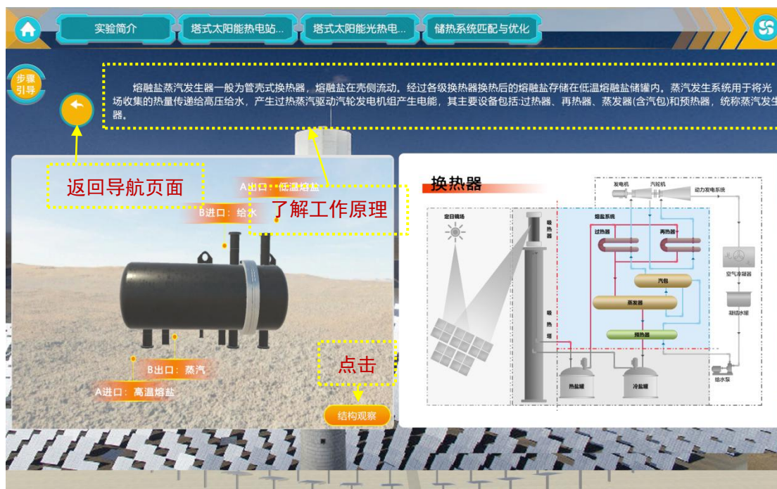
图 7b 塔式太阳能光热电站换热子系统——换热器外观
