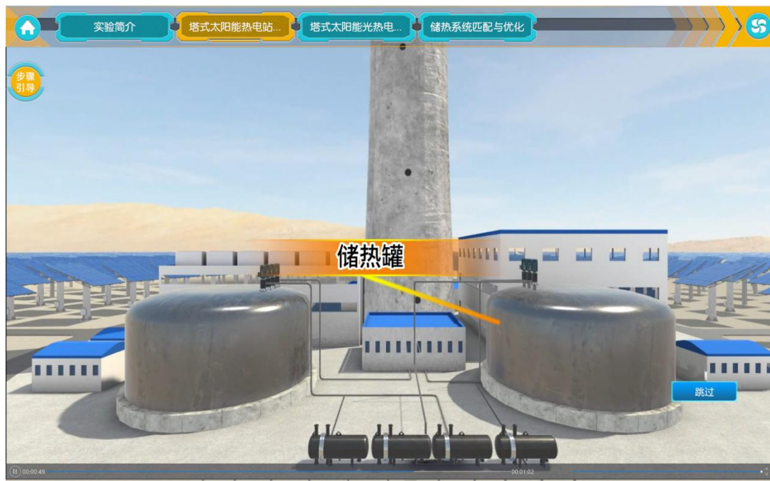
图 3e 电站巡航动画——储热罐
