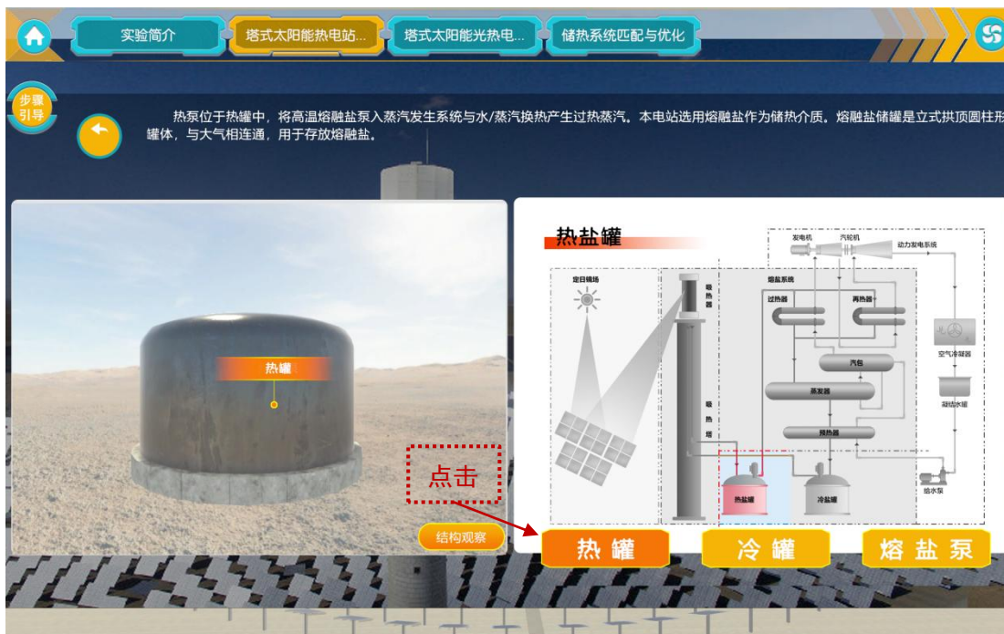
图 6b 塔式太阳能光热电站储热子系统——热罐外观
